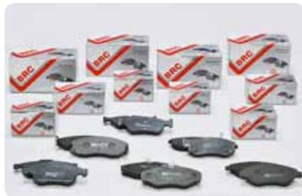
Le pastiglie freno BRC Brake presentano un sottostrato termico, detto underlayer, tra materiale d'attrito e supporto metallico, che agevola la dissipazione del calore. In questo modo si evitano problemi di surriscaldamento, guarnizioni pinza danneggiate e fading di frenata. Proprietà anticorrosive integrate, evitano il rischio di grippaggio dei freni. Le misure dello spazio di frenata registrato tramite acquisitori, dimostrano l'elevato potere di attrito e prestazionale del prodotto.
